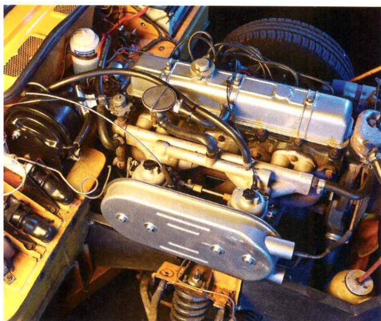
Nach dem Öffnen der Motorhaube ist die Sechszylinder-Maschine gut zugänglich, und Teile der Radaufhängung sind sichtbar
