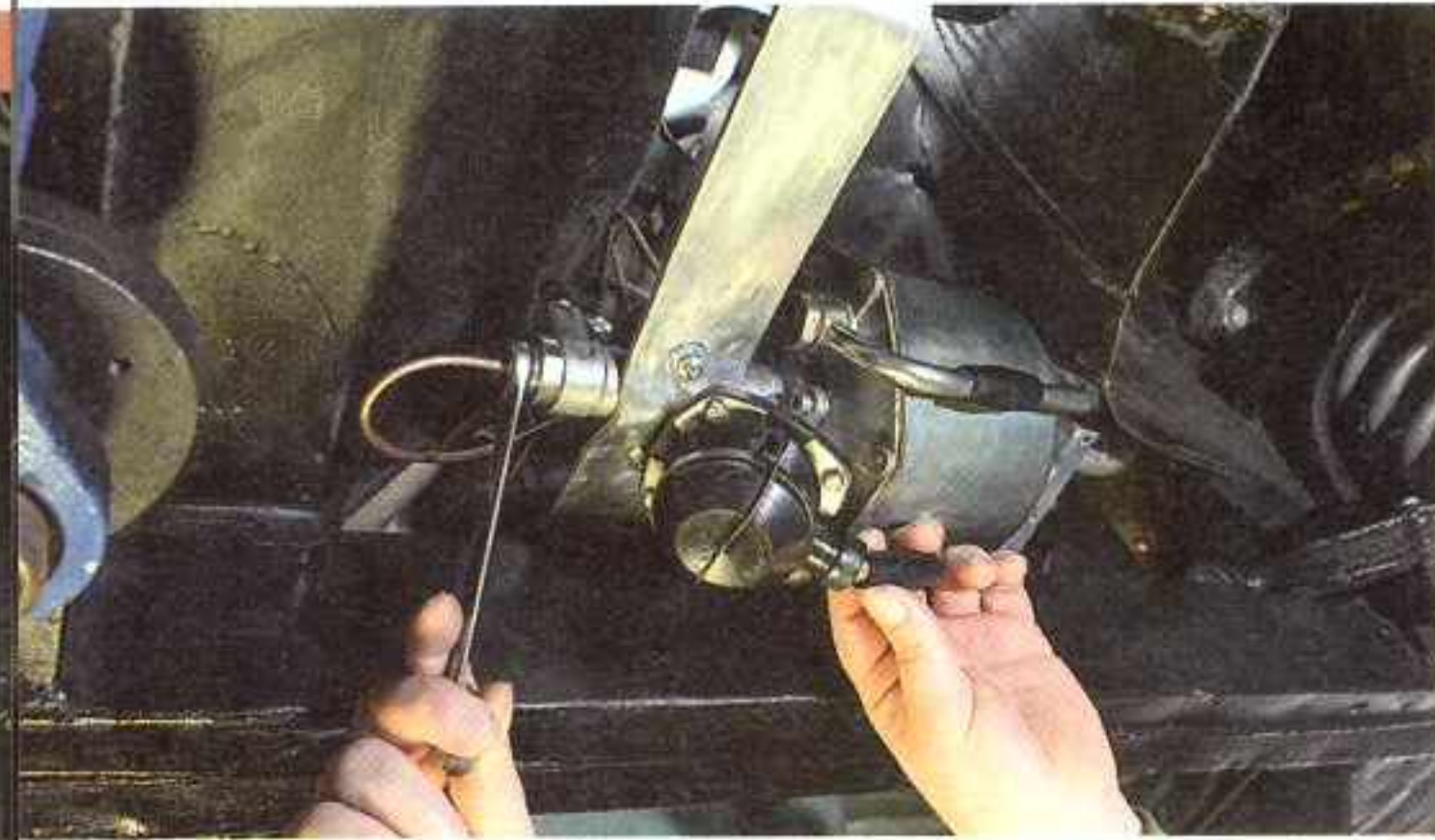
Als Halterungen haben die Spezialisten nichtrostende Aluprofile verwendet; sie umgreifen die Zylinder des Bremskraftverstärkers und halten ihn sicher. Die originale Bremsleitung (Bild rechts) wird bis zum Verstärker verlängert, die Rückleitung von diesem wird wieder am serienmäßigen Verteilerstück angeschraubt
