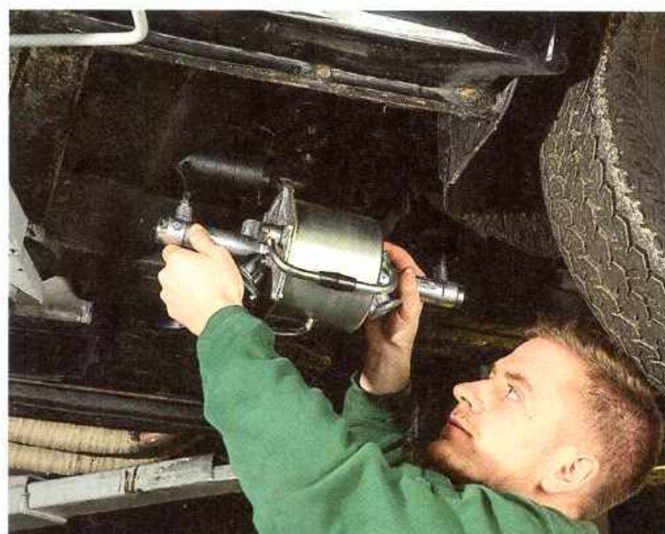
Es geht auch in der Nähe der Spritzwand eng im Healey zu. Die einzige Möglichkeit, den Bremskraftverstärker unterzubringen, ist der Bereich hinterm rechten Radkasten. Dazu müssen Halterungen angefertigt werden
