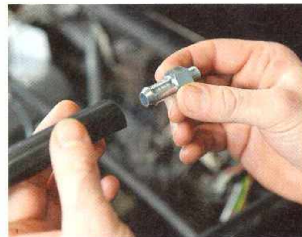
Links wird der Schlauch aufgesteckt, rechts ist ein feines Schraubgewinde
