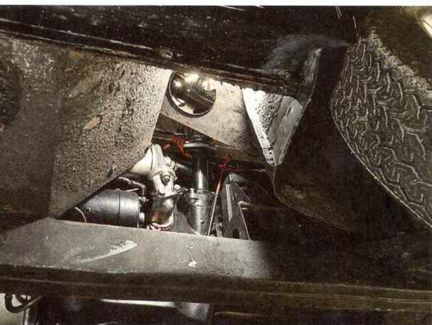
Es geht auch in der Nähe der Spritzwand eng im Healey zu. Die einzige Möglichkeit, den Bremskraftverstärker unterzubringen, ist der Bereich hinterm rechten Radkasten. Dazu müssen Halterungen angefertigt werden
