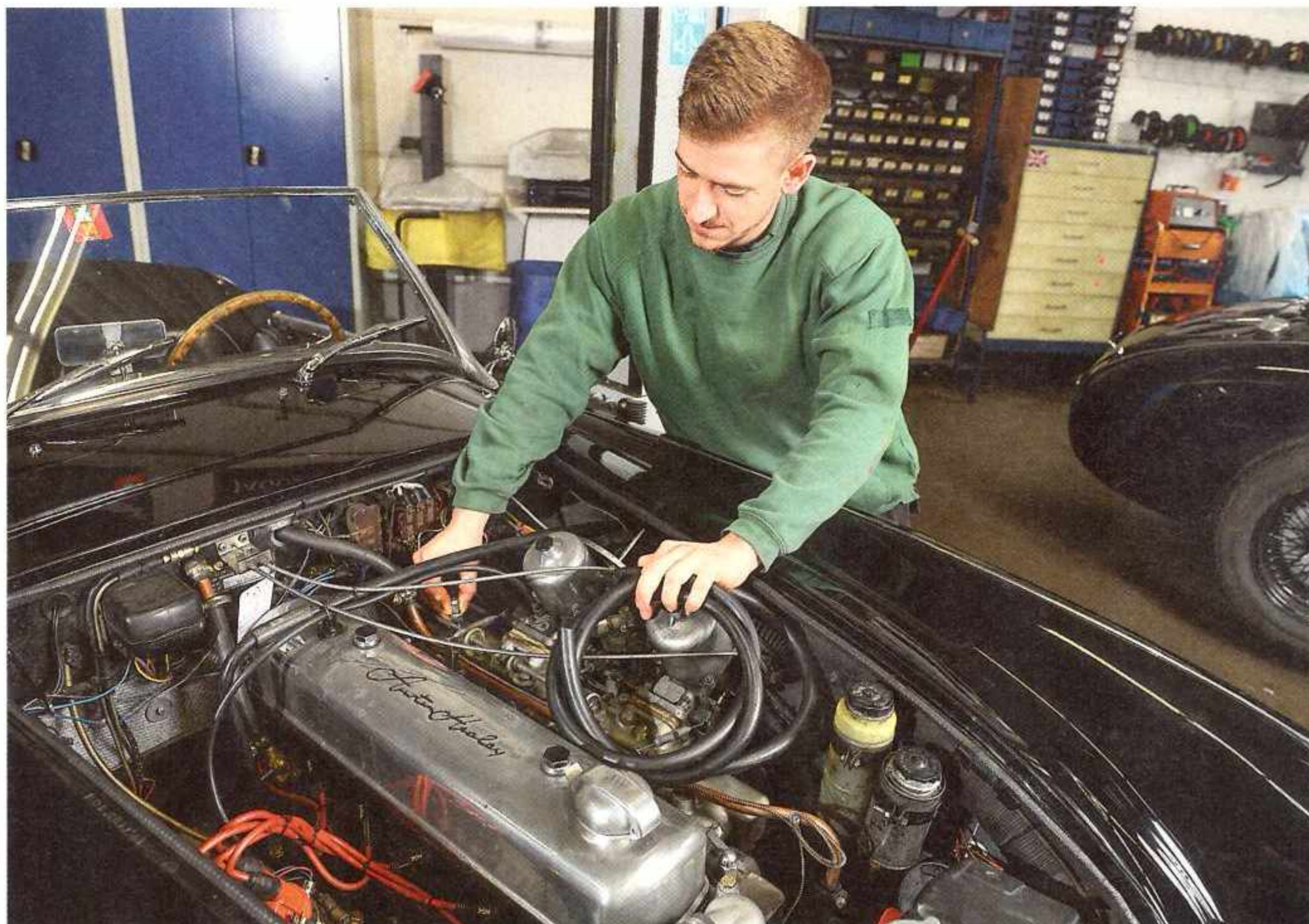
Entscheidend für die Funktion des Bremskraftverstärkers ist der Unterdruckanschluss. Bei Mehrvergaseranlagen mit Ausgleichsleitungen kann man diese „anzapfen“, ansonsten ist Bohren angesagt: Es gibt Stutzen für die Ansaugbrücke
